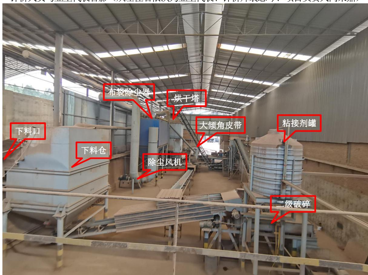
现场照片 1 磷矿粉成球生产车间概貌图
